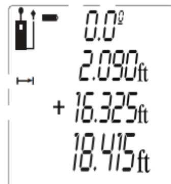
Fig.7. L'afficheur montre l'addition d'une mesure de 16.325 pied et d'une mesure de 2.090 pied.
