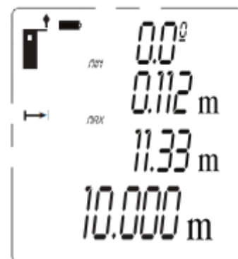
Fig. 6. Les possibilités d'une mesure continue pour mesurer une distance spécifiée (10m) à partir d'un mur
