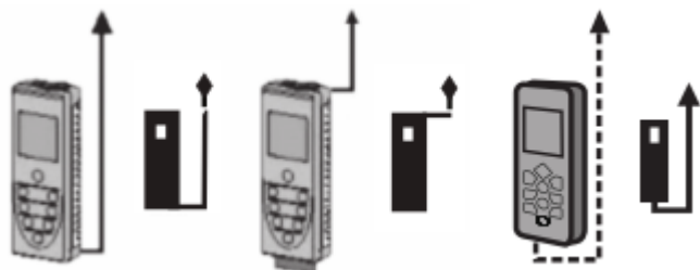
Fig. 3. Référencer des mesures à partir du bas (gauche) et du haut (centre) du boîtier du télémètre ou à partir de la réglette du télémètre (droite)
