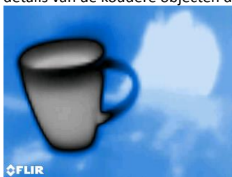
Fig. 5-7(a) Automatisch op schaal brengen van palet ontgrendeld
