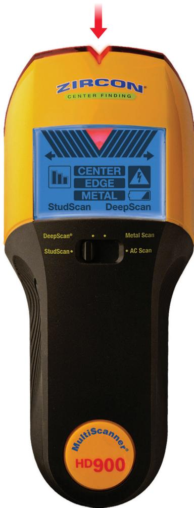
Le MultiScanner™ HD900 localise de façon aisée et rapide le centre et les bords de montants et solives derrière murs, plafonds et planchers. Il localise aussi le métal et les fils électriques sous tension alternative AC. Un commutateur à 4 modes facilite le changement de fonctions tandis que l'afficheur ultrabrillant, le Pointeur SpotLite® et un signal sonore indiquent la localisation de la cible. L'indicateur de Puissance du Signal permet de distinguer entre des cibles profondes ou non.
