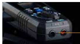
Entrée fils de test
