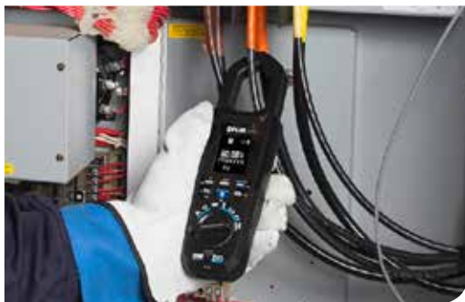
Vérifier les mesures d'intensité
