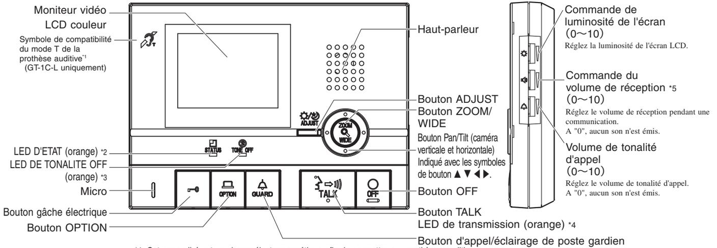
\*1: Cet appareil émet un champ électromagnétique afin de permettre aux prothèses auditives dotées du mode T de produire un son clair.
