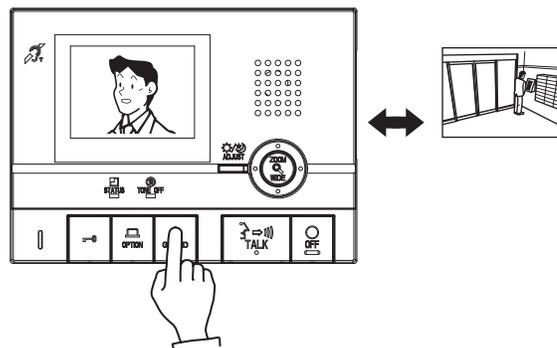
⚠ Lors du passage entre caméra d'entrée et caméra de surveillance dans une aire commune, il se peut que l'image du moniteur soit momentanément déformée, mais il ne s'agit pas d'un dysfonctionnement.
