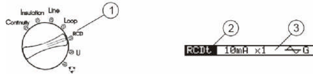
Figure 4.2 : commutateur rotatif et ligne de paramètres associée
