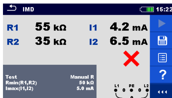
Image 7.68: Exemples de résultat de mesure CPI.
