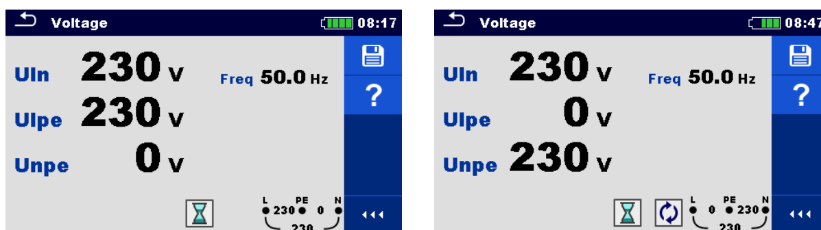
Image 7.4: Exemple de mesure de tension dans un système monophasé.
