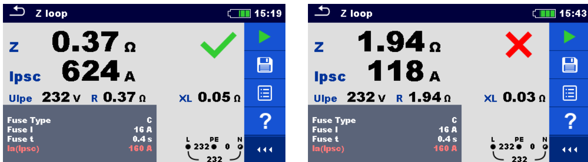
Image 7.25: Exemple de résultat de mesure d'impédance de boucle.
