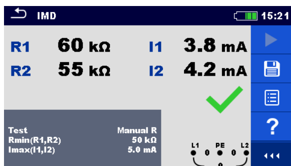
Image 7.68: Exemples de résultat de mesure CPI.
