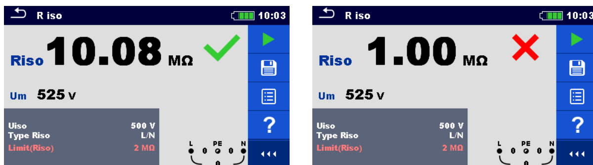
Image 7.8: Exemple de résultats de mesure de résistance d'isolement
