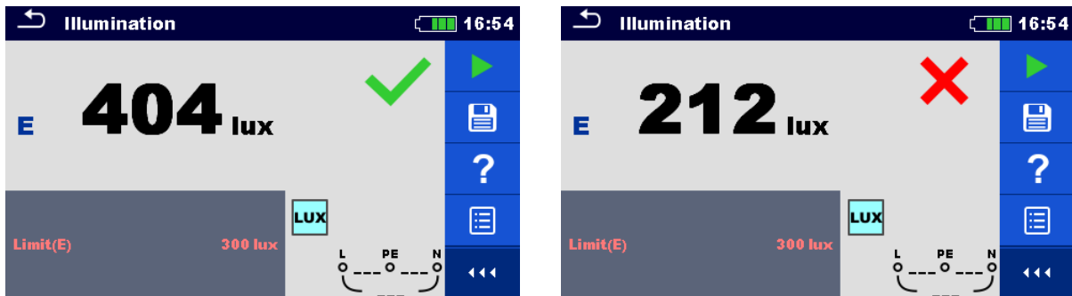
Image 7.74: Exemples de résultat de mesure d'éclairement.
