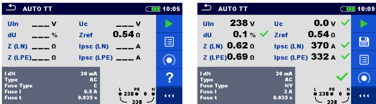
Image 8.5: Exemple de résultats de mesure AUTO TT.
