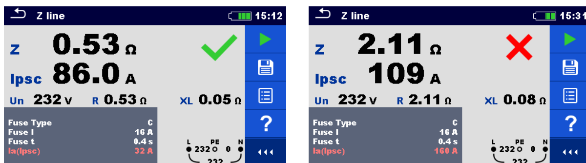
Figure 7.35: Exemple de résultat de mesure d'impédance de ligne;
