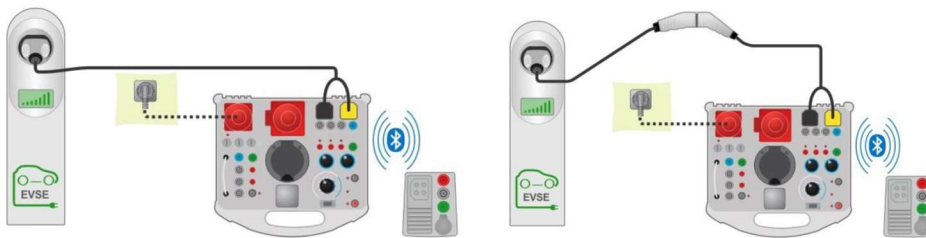
Figuur 5.7: Diagnose test – EV-simulator test verbinding naar modus 3 EVSE
