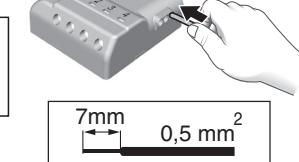
Ne pas dénuder les fils lorsqu'ils sont connectés sur le produit au risque d'endommager le connecteur interne.
