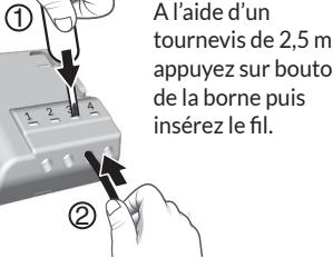
A l'aide d'un tournevis de 2,5 mm appuyez sur bouton de la borne puis insérez le fil.
