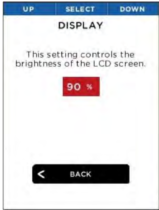
Figure 30: Réglage de la luminosité de l'écran
