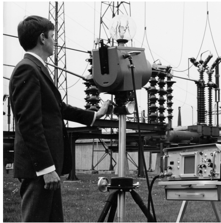
Figure 13.2 1969 : Thermovision, modèle 661. La caméra pesait environ 25 kg, l'oscilloscope 20 kg et le trépied 15 kg. L'opérateur avait également besoin d'un groupe électrogène de 220 V CA et d'un récipient contenant 10 l d'azote liquide. A gauche de l'oscilloscope, on distingue le Polaroid (6 kg).
