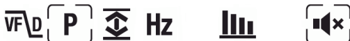
Figuur 5.2 Moduspictogrammen (wisselspanningsmetingen): de modus Peak (piek) en de modus Silent (stil) zijn ingeschakeld
